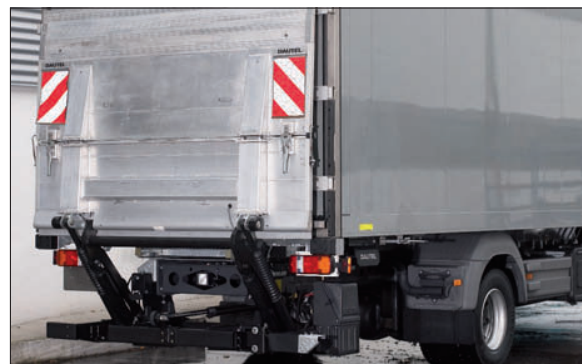
2-częściową platformę można również ustawić pionowo
